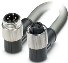
Cable de potencia, 5-polos, PVC, gris RAL 7001, Conector acodado 7/8"-16UNF, codificación: A, a Hembra acodado 7/8"-16UNF, longitud de cable: 0,3 m, Sección del conductor 2,5 mm<sup>2</sup>, para el suministro de energía
