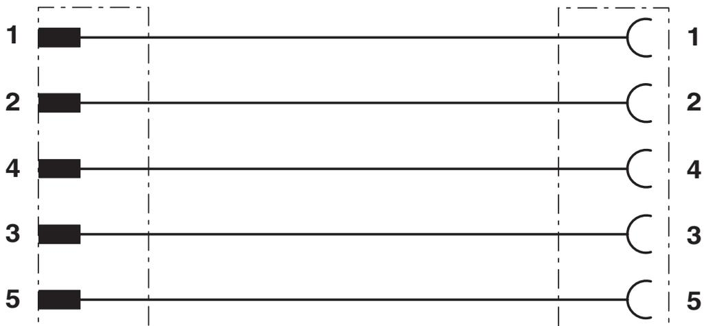
Ocupación de contactos del conector macho 7/8" y del conector hembra 7/8"
