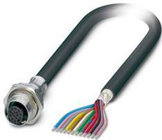
Conect. enchuf. para apar. pared poster., Universal, 12-polos, PVC/PVC, negro RAL 9005, apantallado, Hembra de conexión, recto, M12-SPEEDCON, A-codificación, a extremo de cable libre, Conexión de cable, longitud de cable: 2 m, 0,14 mm<sup>2</sup>, PVC negro, se espera que este artículo no contenga plomo a partir del segundo trimestre de 2026 de acuerdo con RoHS II sin excepción 6c (Pb <0,1 %), una alternativa sin plomo está disponible previamente a petición
