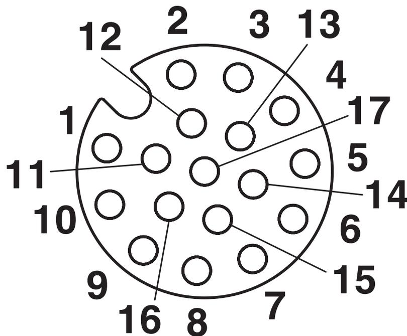
Esquema polos del conector hembra M12, 17 polos, cod. A, vista de cara de hembras
