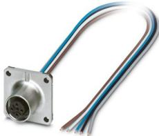
Conect. enchuf. para apar. pared delant., 5-polos, Hembra de conexión, recto, M12, B-codificación, a extremo de cable libre, Hilos trenzados individuales, longitud de cable: 0,5 m, 0,34 mm<sup>2</sup>, Hilo trenzado TPE, encapsulado, se espera que este artículo no contenga plomo a partir del segundo trimestre de 2026 de acuerdo con RoHS II sin excepción 6c (Pb <0,1 %), una alternativa sin plomo está disponible previamente a petición
