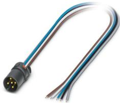
Soporte de contactos, 4-polos, Conector macho, recto, M12, A-codificación, a extremo de cable libre, Hilos trenzados individuales, longitud de cable: 0,5 m, 0,34 mm<sup>2</sup>, Hilo trenzado TPE, se espera que este artículo no contenga plomo a partir del primer trimestre de 2026 de acuerdo con RoHS II sin excepción 6c (Pb <0,1 %), una alternativa sin plomo está disponible previamente a petición
