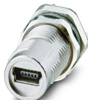
Conect. enchuf. para apar. pared delant., 4-polos, Hembra de conexión, recto, M12-SPEEDCON, Soldadura por ola, se espera que este artículo no contenga plomo a partir del segundo trimestre de 2026 de acuerdo con RoHS II sin excepción 6c (Pb <0,1 %), una alternativa sin plomo está disponible previamente a petición
