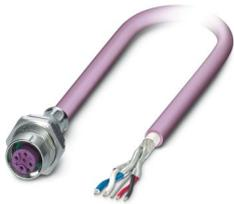
Hembra de montaje incorporado para sistema de bus, DeviceNet/CANopen, 5 polos, M12, apantallada, codificada A, Speedcon, montaje en paredes posteriores/montaje atornillado con rosca Pg9, con cable de bus de 0,5 m, 2 x 0,2 mm<sup>2</sup>; 2 x 0,32 mm<sup>2</sup>
