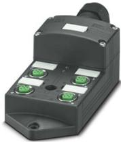
Caja distribuidora, tipo de conexión: Conector hembra M12 Metal, número de puestos enchufables: 4, número de polos: 5, codificación: A, ocupación de los puestos enchufables: paralelo, indicación de estado: no, Universal; conexión de cable principal: Conexión por tornillo enchufable 180°, apantallamiento: no
