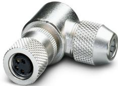
Conector, Universal, 4-polos, apantallado, Hembra de conexión acodado M8, codificación: A, Conexión por soldadura, material de moleteado: Latón, niquelado, diámetro exterior del cable 3,5 mm ... 5 mm
