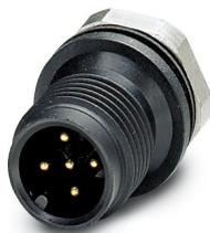
Conector enchufable de montaje incorp. p/ sensores/actuadores, conector, 5 polos, M12, codificado A, montaje en paredes delanteras/montaje atornillado con rosca M12, con copas de soldar, en ejecución de plástico
