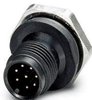
Conector enchufable de montaje incorporado para sensores/actuadores, macho, 8 polos, M12, codificado A, montaje en paredes delanteras / montaje atornillado con rosca M16, con copas de soldar, en ejecución de plástico
