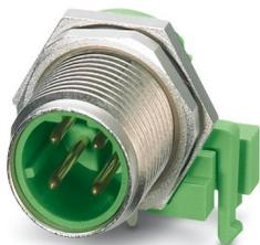
Conector enchufable de montaje incorporado para sistema de bus, conector macho, Ethernet, 4 polos, M12, apantallado, codificada D, montaje en paredes posteriores / montaje atornillado, con conexión por soldadura acodada
