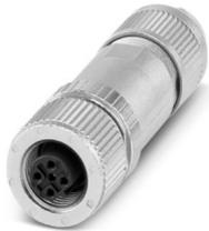
Conector, 5-polos, apantallado, Hembra de conexión recto M12 SPEEDCON, codificación: B, Conexión por resorte, material de moleteado: Fundición inyectada de cinc, niquelada, diámetro exterior del cable 4 mm ... 8 mm
