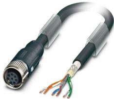
Cable de sistema de bus, VARAN (100 MBit/s), 6-polos, SANTOPRENE sin halógenos/TPE sin halógenos, negro RAL 9005, apantallado, extremo de cable libre, a Hembra recta M12 SPEEDCON, codificación: A, longitud de cable: 2 m
