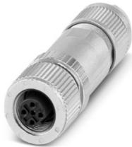
Conector para datos, PROFIBUS DP (12 MBit/s), 2-polos, apantallado, Hembra de conexión recto M12, codificación: B, Conexión por resorte push lock, material de moleteado: Fundición inyectada de cinc, niquelada, diámetro exterior del cable 4 mm ... 8 mm
