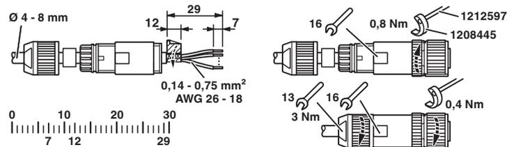
Deslice la tuerca de apriete y la carcasa aérea en el cable, pele el cable, acorte la pantalla, pele los conductores, conecte los conductores, con la carcasa aérea recta tuerza los conductores entre sí, pegue una lámina de pantalla alrededor de la pantalla acortada, si diámetro exterior del cable es <6 mm pegue una lámina de pantalla adicional alrededor del paquete de conductores, atornille la carcasa aérea con el inserto del conector, apriete la tuerca de apriete.
