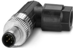
Conector, Universal, 5-polos, sin apantallar, Conector macho acodado M12, codificación: A, Conexión por resorte push lock, material de moleteado: Fundición inyectada de cinc, niquelada, diámetro exterior del cable 4 mm ... 8 mm
