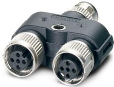
Distribuidor en Y, 5-polos, apantallado, Conector recta M12 SPEEDCON, codificación: A, a Hembra recta M12 SPEEDCON, codificación: A y Hembra recta M12 SPEEDCON, codificación: A, boquilla de purga paralela
