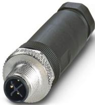
Conector de potencia, 3-polos, Conector macho recto M12, codificación: S, Conexión por tornillo, material de moleteado: Fundición inyectada de cinc, niquelada, prensaestopas Pg9, diámetro exterior del cable 6 mm ... 8 mm, para corriente alterna hasta 16 A/630 V, Contacto 4 en avance
