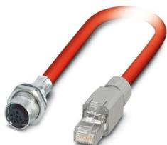
Cable Sercos III confeccionado, apantallado, de cuadretes en estrella, AWG 22 flexible (7 hilos), RAL 3020 (rojo), conector hembra de montaje incorporado M12, montaje en paredes posteriores, SPEEDCON de 4 polos a conector libre RJ45/IP20, longitud: 2 m
