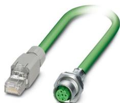
Cable EtherCAT® confeccionado, apantallado, de cuadretes en estrella, AWG 22 flexible (7 hilos), RAL 6018 (amarillo-verde), conector hembra de montaje incorporado M12, SPEEDCON, 4 polos a conector macho RJ45/IP20, longitud: 2,0 m
