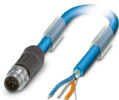
Cable de sistema de bus, PROFIBUS PA (31,25 kBit/s), 3-polos, PVC, azul RAL 5015, apantallado, Conector recta M12, codificación: A, a extremo de cable libre, longitud de cable: 20 m, para zona Ex con moleteado acero inox.
