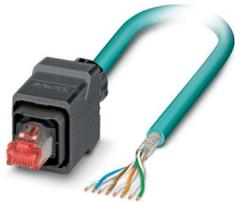
Cable Ethernet confeccionado, CAT6, apantallado, 4 pares, AWG 26 flexible (7 hilos), RAL 5021 (azul agua), conector macho RJ45/IP67, "push-pull", carcasa de plástico, a extremo de cable libre, Line, longitud 5 m
