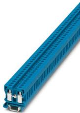
Miniborna de paso, tensión nominal: 500 V, corriente nominal: 32 A, número de conexiones: 2, tipo de conexión: Conexión por tornillo, 1er piso, sección: 0,2 mm<sup>2</sup> - 4 mm<sup>2</sup>, clase de montaje: NS 15, color: azul
