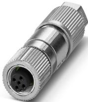
Conector, Universal, 5-polos, sin halógenos, apantallado, Hembra de conexión recto M12, codificación: A, Conexión por desplaz. de aislamiento, material de moleteado: Fundición inyectada de cinc, niquelada, diámetro exterior del cable 5 mm ... 9,7 mm
