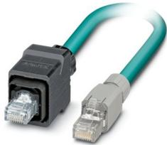
Cable Ethernet confec., apantall., 4 pares, AWG 26 apto p. cadenas de sumin. energía (19 hilos), RAL 5021 (azul agua), conec. macho RJ45/IP67 push pull carc. de plástico en conec. macho RJ45/IP20, Line, long. 2 m
