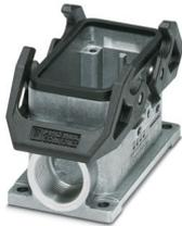
Carcasa de superficie B10, con brida transversal, material: Fundición inyectada de aluminio, resistente al agua de mar, salidas de cable: 2, lateral, 2x M20, altura: 54 mm, prensaestopas: sin, Estándar
