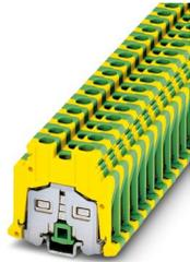
Borna de tierra, En una alineación conjunta con borne de paso de igual contorno, debe utilizarse una placa separadora de zonas para tensiones de aislamiento > 250 V, número de conexiones: 2, tipo de conexión: Conexión por tornillo, 1er piso, sección: 0,5 mm<sup>2</sup> - 10 mm<sup>2</sup>, tipo de sujeción: Pie PE con tornillo de fijación, M4, clase de montaje: NS 15, color: amarillo-verde
