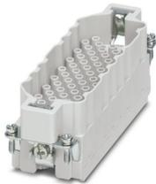
Inserto de contactos, número de polos: 64+PE, tamaño: B24, número de conexiones por polo: 1, Macho, Conexión crimpada, 500 V, 16 A, 0,5 mm<sup>2</sup> ... 4 mm<sup>2</sup>
