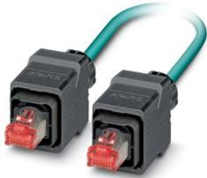
Cable Ethernet confeccionado, CAT5e, apantallado, 2 pares, AWG26 flexible (7 hilos), RAL 5021 (azul agua), conector macho RJ45/IP67 push pull carcasa de plástico en conector macho RJ45/IP67 push pull carcasa de plástico, Line, longitud 10 m
