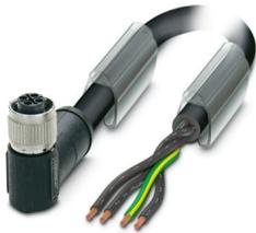
Cable de potencia, 4-polos, PUR sin halógenos, negro grisáceo RAL 7021, extremo de cable libre, a Hembra acodado M12, codificación: S, longitud de cable: 10 m, para corriente alterna hasta 12 A/690 V
