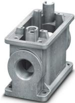
Carcasa zócal HEAVYCON ADVANCE B10, para bloqueo por tornillo M6, aluminio resistente al agua de mar, con 2 roscas M25, sin superficie
