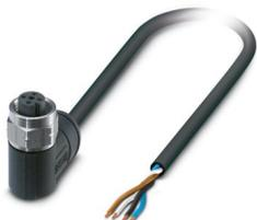
Cable para sensores/actuadores, 4-polos, PE-X sin halógenos, negro grisáceo RAL 7021, extremo de cable libre, a Hembra acodado M12, codificación: A, longitud de cable: 2 m, para aplicaciones exteriores, con moleteado de acero inoxidable
