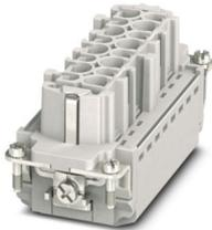
Inserto de contactos, número de polos: 16+PE, tamaño: B16, número de conexiones por polo: 1, Hembra, Conexión push-in, 500 V, 16 A, 0,14 mm<sup>2</sup> ... 2,5 mm<sup>2</sup>, aplicación: Potencia
