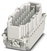
Inserto de contactos, número de polos: 16+PE, tamaño: B16, número de conexiones por polo: 1, Macho, Conexión push-in, 500 V, 16 A, 0,14 mm<sup>2</sup> ... 2,5 mm<sup>2</sup>, aplicación: Potencia
