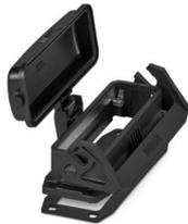
Carcasa empotrada B24, con brida longitudinal, material: PA 6.6-FR, material tapa protectora: PC, altura: 30,5 mm, prensaestopas: sin, tapa de protección: sí, Estándar, con junta plana
