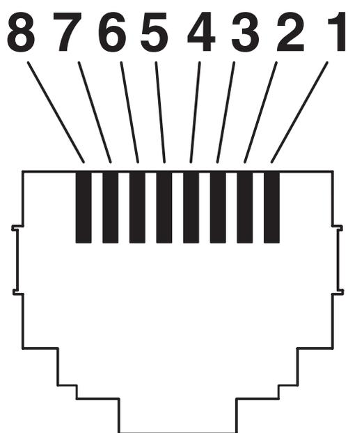
Esquema de polos del conector macho RJ45
