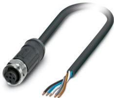
Cable para sensores/actuadores, 5-polos, PE-X sin halógenos, negro grisáceo RAL 7021, extremo de cable libre, a Hembra recta M12, codificación: A, longitud de cable: 2 m, para aplicaciones exteriores, con moletado de acero inoxidable
