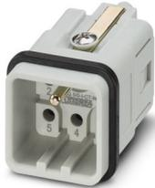
Inserto de contactos, número de polos: 5+PE, tamaño: D7, número de conexiones por polo: 1, Macho, Conexión crimpada, 230 V/400 V, 20 A, 0,5 mm<sup>2</sup> ... 2,5 mm<sup>2</sup>, aplicación: Potencia
