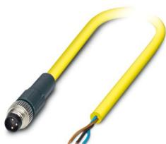
Cable para sensores/actuadores, 3-polos, PVC, amarillo, Conector recta M8, a extremo de cable libre, longitud de cable: 2 m
