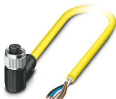
Cable para sensores/actuadores, 5-polos, PVC, amarillo, apantallado, extremo de cable libre, a Hembra acodado M12, codificación: A, longitud de cable: 10 m
