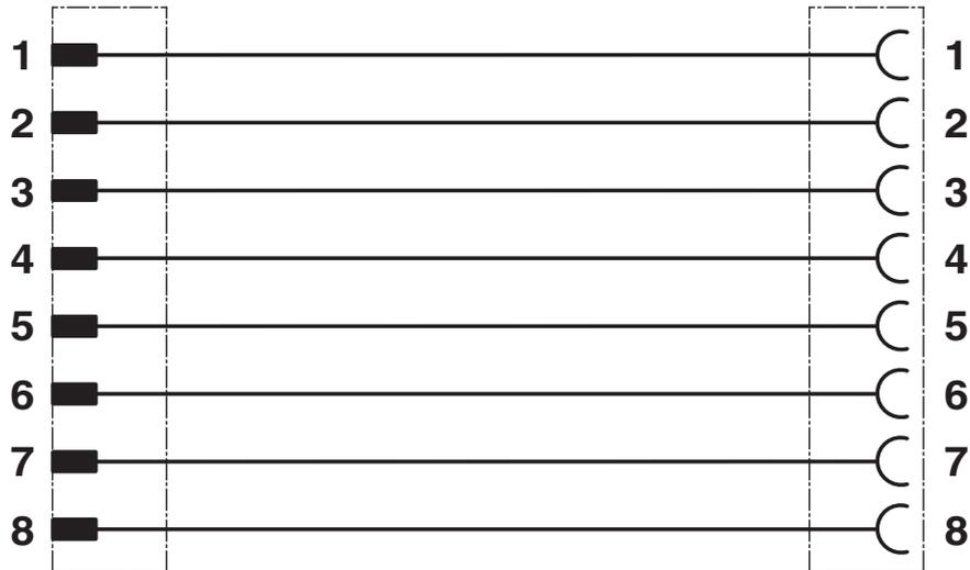
Ocupación de contactos del conector macho M12 y del conector hembra M12
