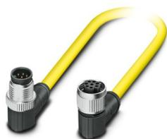
Cable para sensores/actuadores, 8-polos, PVC, amarillo, Conector acodado M12, codificación: A, a Hembra acodado M12, codificación: A, longitud de cable: 0,5 m
