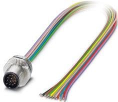
Conect. enchuf. para apar. pared delant., Universal, 12-polos, Conector macho, recto, M12-Estándar, A-codificación, a extremo de cable libre, Hilos trenzados individuales, longitud de cable: 0,5 m, 0,14 mm<sup>2</sup>, Hilo trenzado TPE, encapsulado, se espera que este artículo no contenga plomo a partir del cuarto trimestre de 2025 de acuerdo con RoHS II sin excepción 6c (Pb <0,1 %), una alternativa sin plomo está disponible previamente a petición
