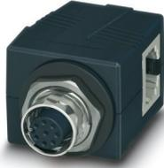
Pasamuros de armario de control, M12, 8 polos, codificado A a conector hembra RJ45, entrada hembra 90°, IP65/67
