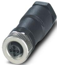
Conector de potencia, Potencia, 4-polos, sin apantallar, Hembra de conexión recto M12, codificación: T, Conexión por tornillo, material de moleteado: Fundición inyectada de cinc, niquelada, prensaestopas Pg11, diámetro exterior del cable 8 mm ... 10 mm, para corriente continua hasta 12 A/63 V
