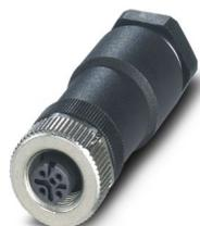
Conector de potencia, 4-polos, Hembra de conexión recto M12, codificación: A, Conexión por tornillo, material de moleteado: Fundición inyectada de cinc, niquelada, prensaestopas Pg11, diámetro exterior del cable 8 mm ... 10 mm
