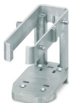
Marco de montaje para carril DIN, diseño: B24, bastidor base, material: fundición de aluminio a presión, sin recubrimiento, abatible 180°, para bastidor superior HC-CIF-B24-HFFD..., para carriles DIN NS 35/7,5
