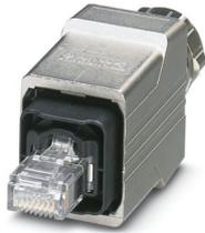
Conector enchufable RJ45, índice de protección: IP65/IP67, número de polos: 8, 1 GBit/s, CAT5 (IEC 11801:2002), material: Metal, tipo de conexión: Conexión rápida IDC, salida de cables: recta, color: plata, Ethernet
