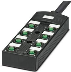
Caja distribuidora, aplicación: Robótica y cadenas de arrastre, tipo de conexión: Conector hembra M12 Metal, número de puestos enchufables: 8, número de polos: 5, codificación: A, ocupación de los puestos enchufables: Doble, indicación de estado: sí, PNP; conexión de cable principal: Conexión fija 180°, PUR sin halógenos altamente flexible, muy flexible, longitud del cable: 5 m, apantallamiento: no
