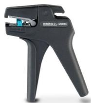
Pelacables, para cables y conductores con una sección de conductor de 0,08 a 2,5 mm<sup>2</sup>, autoajustable, longitud de pelado ajustable hasta 15 mm, capacidad cortante: hasta 6 mm<sup>2</sup> flexible/ hasta 1,5 mm<sup>2</sup> rígido
