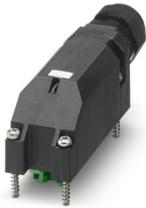
Cubierta de conexiones, aplicación: Estándar, tipo de conexión: Hembra M8 Metal, número de puestos enchufables: 10, número de polos: 3, ocupación de los puestos enchufables: simple, indicación de estado: no, Universal; conexión de cable principal: Conexión por resorte push-in enchufable 180°, apantallamiento: no
