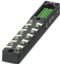
Caja distribuidora de carcasa de base, aplicación: Estándar, tipo de conexión: Hembra M8 Metal, número de puestos enchufables: 10, número de polos: 3, codificación: A, ocupación de los puestos enchufables: simple, indicación de estado: sí, PNP; conexión de cable principal: Conexión enchufable del cable principal, apantallamiento: no
